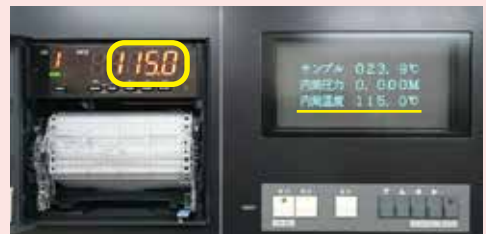
キャリブレーション実施後(正確な温度が表示されています)
